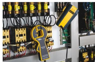
Die Induktions-Zange ermöglicht die Einspeisung eines Signals auf das Kabel ohne direkte Kontaktmöglichkeit (z. B. Kabelkanäle, Kabelschacht)
