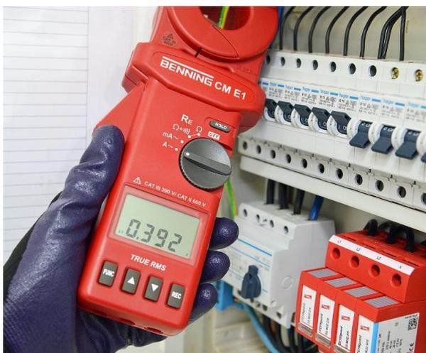
Messung des Gesamt-Ableitstroms in einer Unterverteilung.
