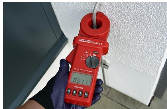
Prüfung einer Blitzschutzanlage mit der BENNING CM E1: Erdleiter mit Zange umfassen, Messwert ablesen, fertig.
