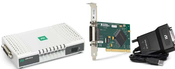
Die Systemintegration von Messgeräten erfolgt über eine GPIB-Schnittstelle. Geräte zur Messgerätesteuerung über GPIB umfassen IEEE-488-Controller, die mit ExpressCard, PMC, PCMCIA, PCIe, PCI und USB sowie Ethernet, RS485, RS422 und RS232 kompatibel sind. Mit einigen Modellen können mehrere GPIB-Geräte gesteuert werden.
