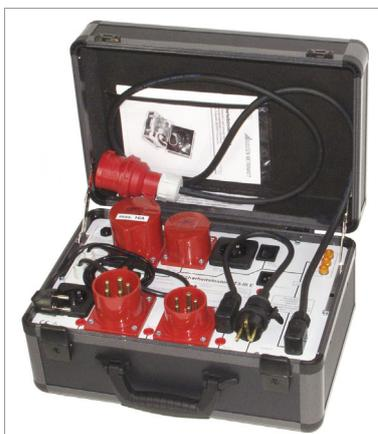
Die Bedienung ist einfach und sicher. Der Prüfadapter wird an eine Drehstromsteckdose 16 A und an das jeweilige Prüfgerät angeschlossen. Die Prüfung erfolgt ohne ein Umstecken der Prüflinge automatisch oder manuell, jeweils vom Programmablauf des Prüfgerätes gesteuert. Bei Überschreitung des werksseitig eingestellten Fehlerstromes erfolgt eine Sicherheitsabschaltung.
