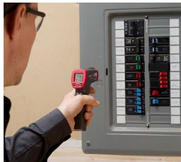
Die helle LC-Anzeige und die rote Laservisierung erleichtern die Überprüfung der Temperatur von Sicherungen, Isolierungen, Leuchtkörpern und mehr – sogar in schlecht beleuchteten Bereichen.
