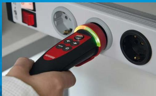
**Commander-Prüfstecker mit TEST-Taste**
