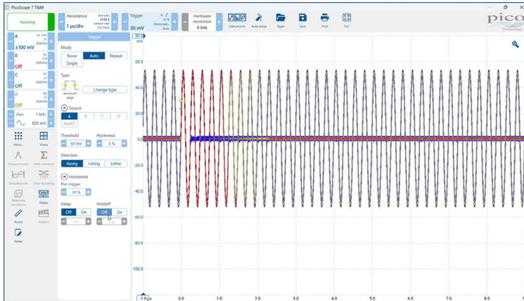
Ohne Triggersperrzeit triggert das Oszilloskop fälschlicherweise auf nachfolgende Impulse im Bündel.
