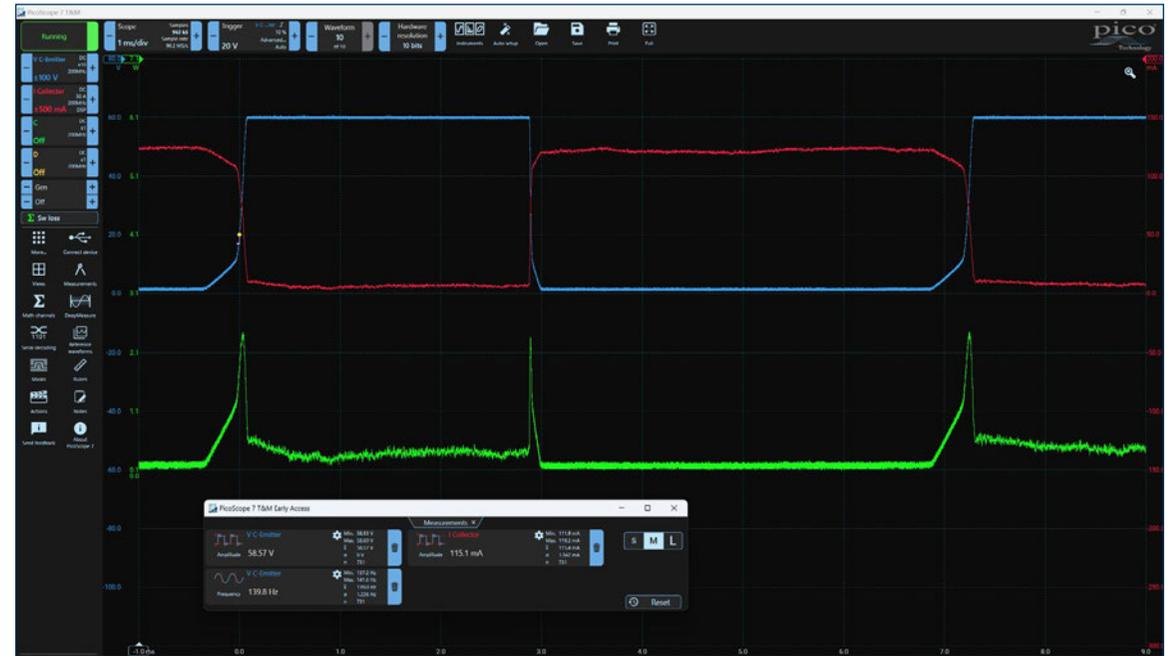
IGBT (Bipolartransistor mit isoliertem Gate) Schaltverlustmessungen
