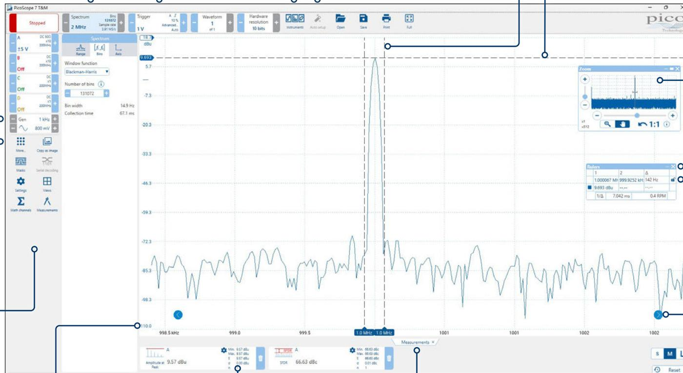
**Vergrößerungsfenster:** Zeigt die vollständigen Wellenformen auf allen aktiven Kanälen. Das graue Rechteck zeigt den Bereich an, der in der derzeitigen Ansicht sichtbar ist.
