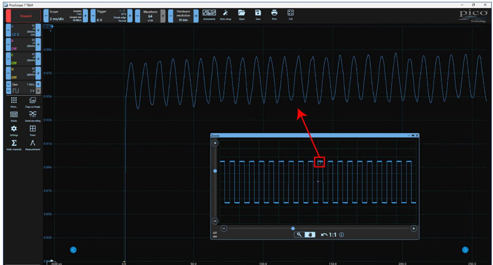
100 kHz Restwelligkeit bei einer 1 kHz-Rechteckwelle, mit 14-Bit-Auflösungsverbesserung
