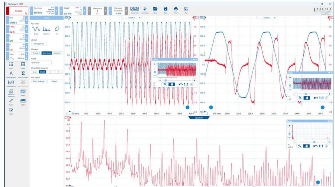
Einschaltsequenz einer induktiven Last
