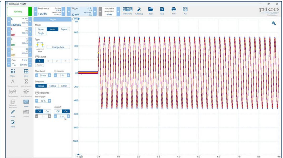
Wenn die Triggersperrzeit richtig eingestellt ist, triggert das Oszilloskop nur beim ersten Impuls des Bündels richtig.
