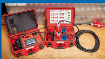
Prüfung einer 5-poligen CEE-Verlängerung
