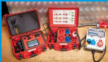
Prüfung einer mobilen Stromverteilung mit RCD
