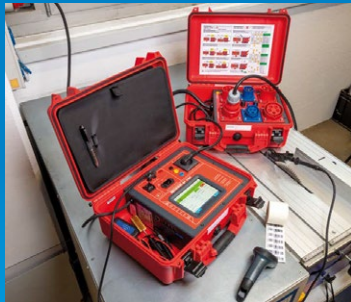
Aktive Prüfung einer 3-phasigen Tischkreissäge
