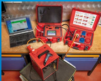
Prüfung eines 3-phasigen Heizlüfters
