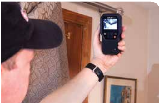
Das FLIR MR160 überprüft einen Decken-/Wandbereich auf Feuchtigkeitsprobleme
