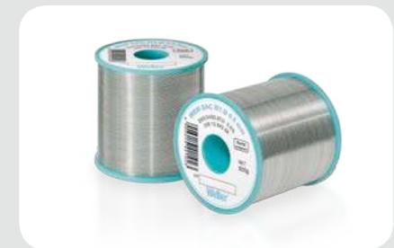
Hervorragendes Schmelzverhalten bei Kupfer und Nickel. Sehr schnelle und homogene Benetzung auch auf schwierigen Oberflächen. Reduzierte Fe-Ablegierung (Leaching). Lötspitzenstandzeiten können durch die Mikrolegierung bis zu 30% verlängert werden. Gute Benetzbarkeit der Lötspitze bei niedrigen Temperaturen. Ein besseres Fließverhalten und geringeres Spritzverhalten des Flussmittels.
