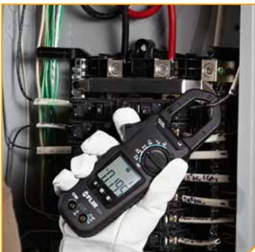
Mit Accu-Tip können Sie präzisere Stromstärkemessungen ausführen
