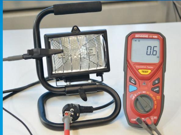
Widerstandsmessung zur Prüfung des Schutzleiters
