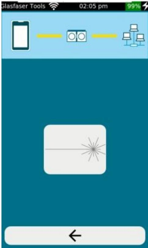
Im **VFL** Test wird die Rotlichtquelle des LinkXpert M3 aktiviert.
