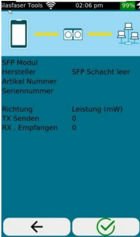
Im **TX/RX** Test werden die Sende (TX für Transmit) und Empfangswerte (RX für Receive) für das SFP Modul sowie Angaben zum SFP Modul ausgelesen.
