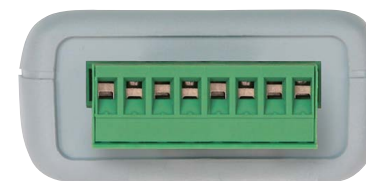
Simple Logger® II Modell L404 Abnehmbare 8-polige Steckerleiste
