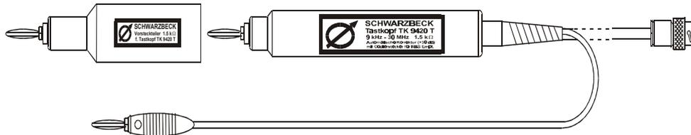
Der Vorsteckteiler (Option) kann zur näherungsweisen Bestimmung von Impedanzen von HF-Störquellen nach CISPR 16-2 herangezogen werden. Es werden zwei Messungen durchgeführt, eine ohne Vorsteckteiler und eine mit Vorsteckteiler. Die Anzeigeänderung der beiden Ablesungen in dB wird verwendet, um aus dem Diagramm die Quellimpedanz des Störers abzulesen. Das genannte Verfahren wird bei höheren Frequenzen (> 10 MHz) zunehmend ungenauer und sollte daher nur als Abschätzung verwendet werden.
