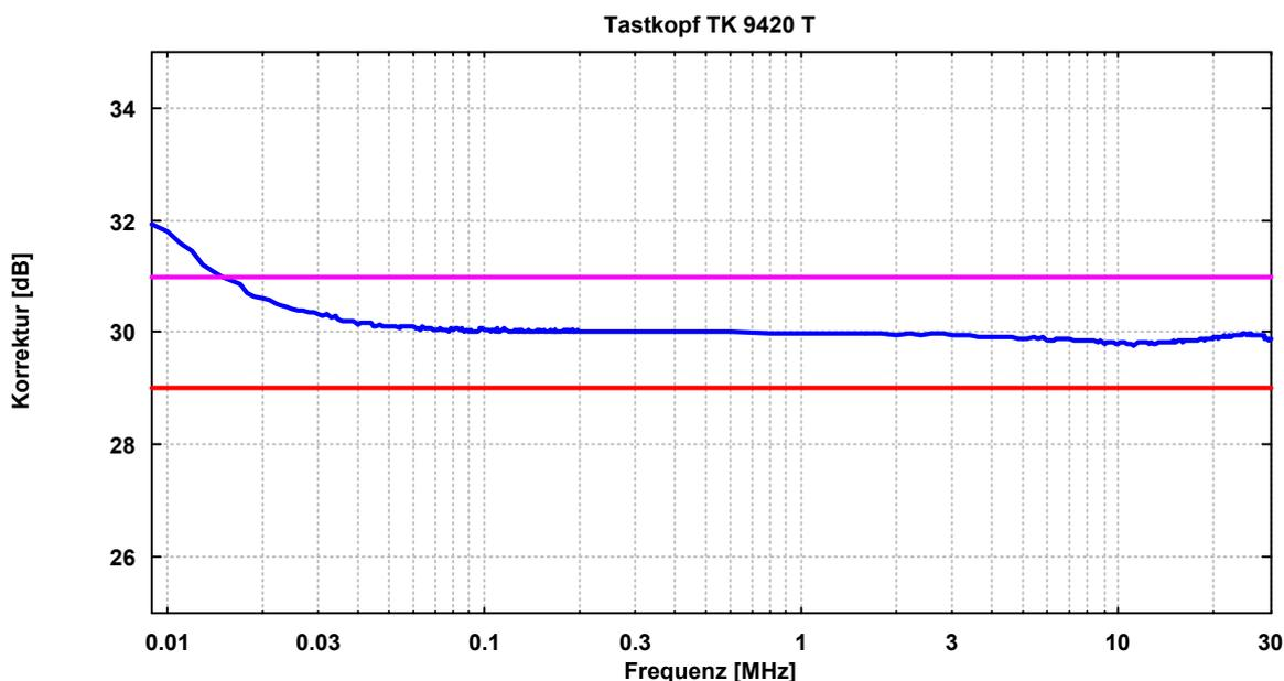
Zur Anzeige eines Meßempfängers mit 50  $\Omega$  Eingang und dB $\mu$ V-Kalibrierung wird im Frequenzbereich 20 kHz - 30 MHz der feste Korrekturwert von 30 dB zur Ablesung hinzugezählt. Das Ergebnis ist die HF-Spannung in dB $\mu$ V an 1.5 k $\Omega$ . Bei Meßfrequenzen unter ca. 20 kHz sind die dB-Korrekturen des obigen Diagramms (statt 30 dB) hinzuzuzählen.
